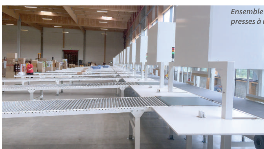
Ensemble de convoyeurs à rouleaux combinés avec convoyeurs à bande pour sortie latérale des pièces transportées.
