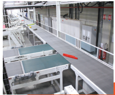
Ensemble de convoyeurs à bande permettant l'asservissement de 16 presses à injecter avec adressages des pièces vers 4 postes de reprise.
